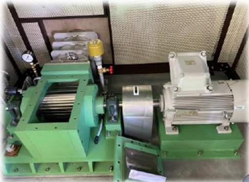
内部のクロスフロー水車
